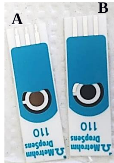
Figura 12: Comparação entre os eletrodos: eletrodepositado com ouro (A) e grafite virgem (B).
