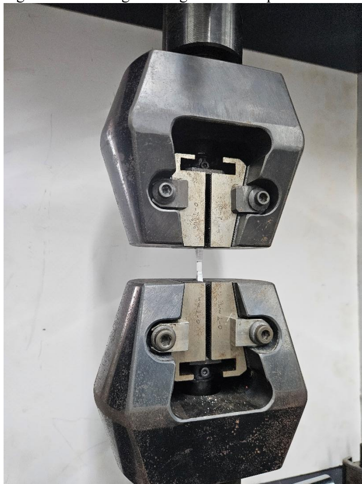
Figura 22 - Montagem das garras na máquina de teste universal.
