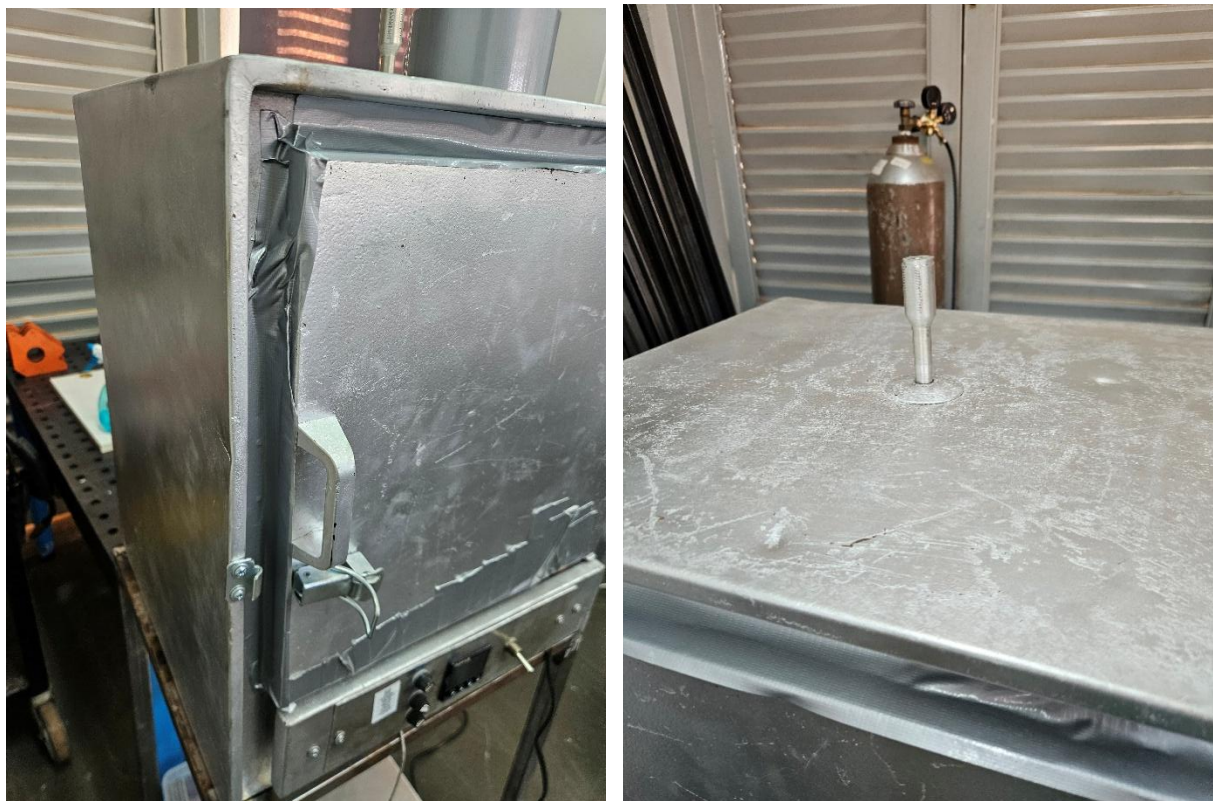
Figura 17 - Vedação adicional na estufa
