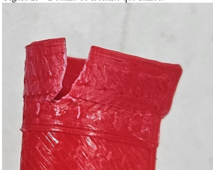
Figura 29 - Detalhe do isolante que falhou.
