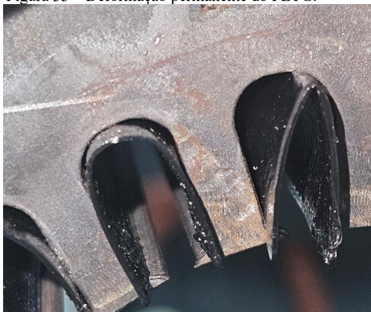
Figura 33 – Deformação permanente do PETG.
