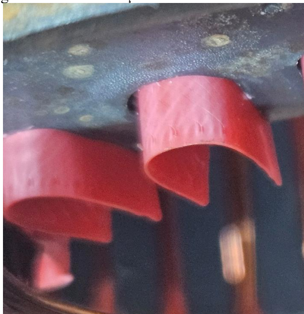
Figura 24 - Descoloração do material ao se flexionar.
