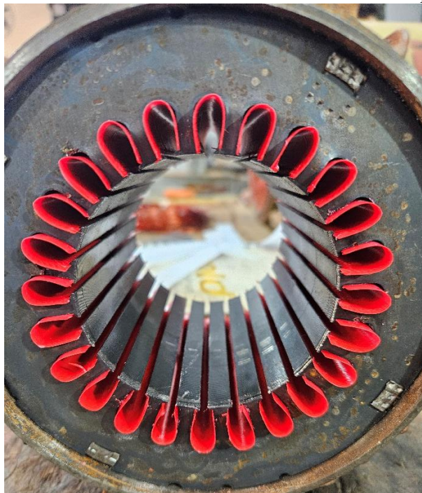
Figura 23 - Estator com isolantes de ranhura montado lado oposto a ligação
