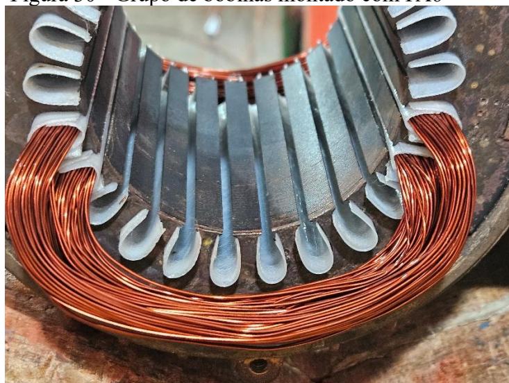
Figura 30 - Grupo de bobinas montado com PA6
