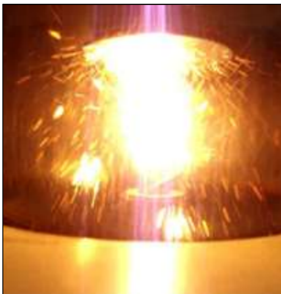
Figura 46 - Reação aluminotérmica em microrreator
