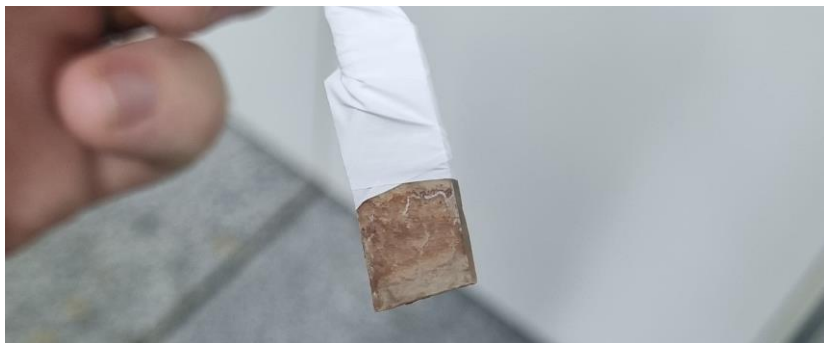
Figura 4.33 - Filme LbL de PAH/PSS/[{CuTBT)} 3 ] aplicado como eletrodo de trabalho.
