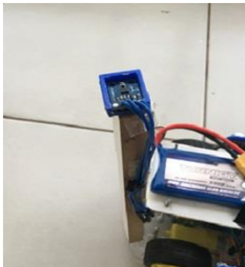
Figura 22 – Bússola HMC 5883 acoplada a haste de madeira
