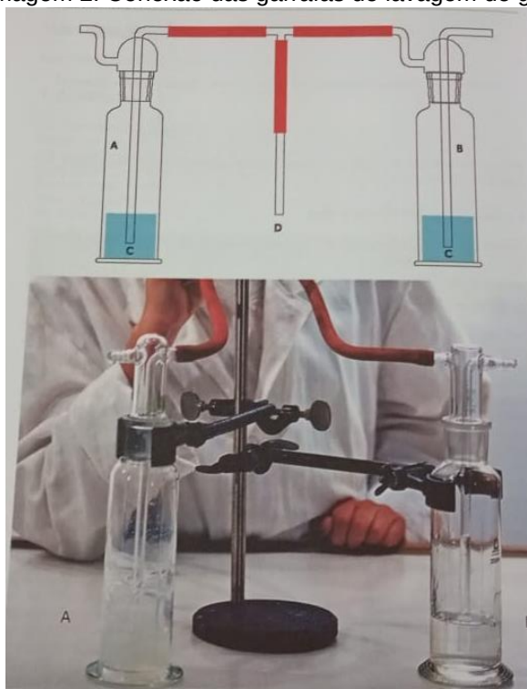
Imagem 2: Conexão das garrafas de lavagem de gás
