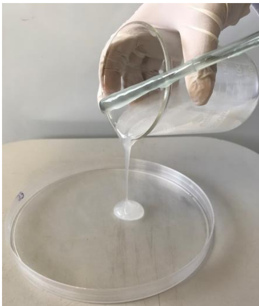
Figura 3 – Sistema viscoelástico após o processo de gelatinização.
