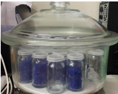
Figura 10 - Células de permeação para cálculo da PVA em dessecador.
