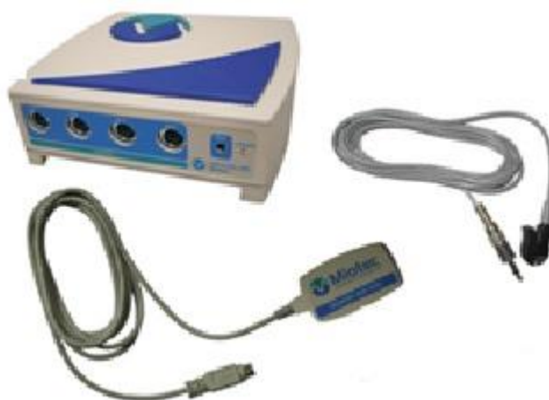
Figura 7 - Eletromiógrafo Miotool 400 USB e sensor bipolar ativo diferencial.
