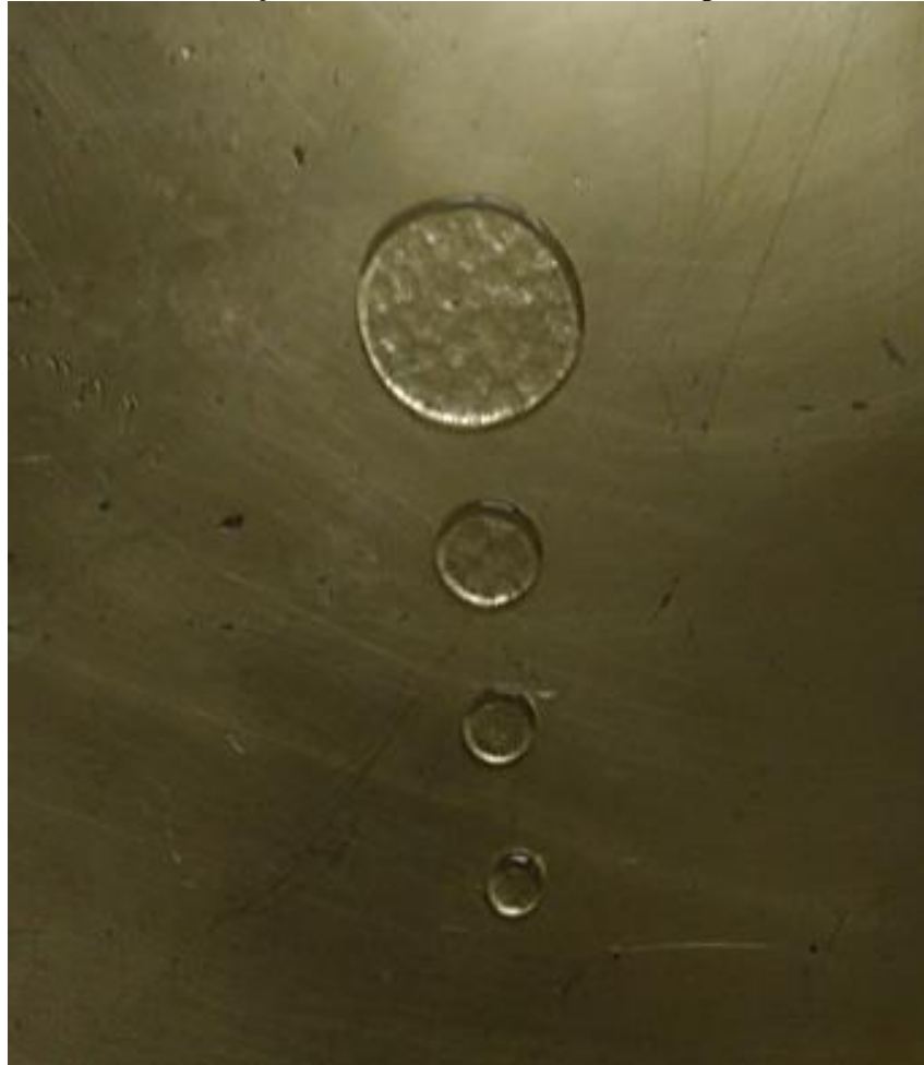
Figura 26 – Solidificação das amostras vítreas em chapa metálica de latão.
