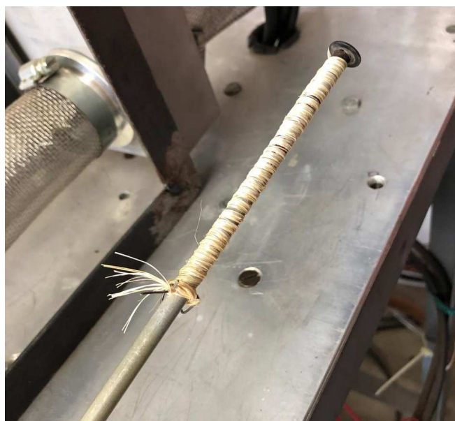
Figura 19: Fibra disposta no porta-amostras do equipamento de plasma para tratamento superficial.
