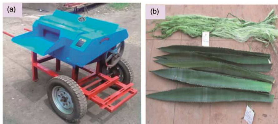
Figura 5: Raspador (a) e folhas da planta de sisal (b).
