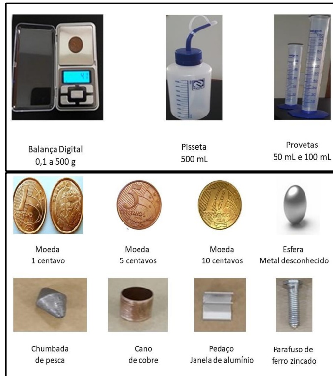
Figura 4 – Materiais utilizados para a determinação da densidade de objetos metálicos.
